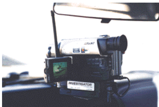
Fot. 2 System Investigator w pozycji roboczej przed szybą
