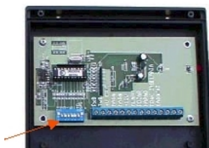
Rys.1 Płytkę elektroniczną z mikroprzełącznikiem i listwą zaciskową
